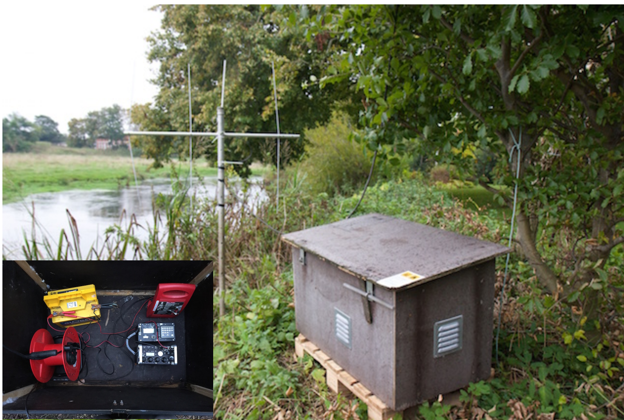
Figur 2.3: Lyttestation placeret ved brinken af Kongeåens hovedløb. I nederste venstre hjørne ses eksternt batteri, modtager og datalogger, som er placeret i kassen for beskyttelse mod vejret.
