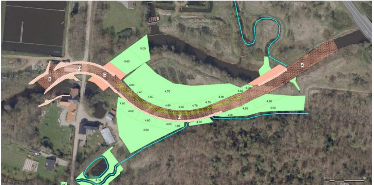
Figur 3-6 Terrænregulering (okker viser tilkørt moræne, grøn jord fra stryget)
