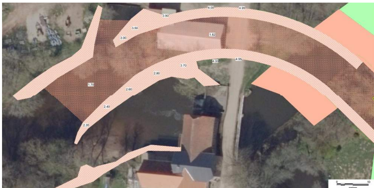
Figur 3-3 Afslutningen af stryget. Tallene angiver koter. Figuren viser forholdene ved bunden. Normalt vil det meste af "tangen" og erosionssikringen være dækket af vand. Den viste erosionssikring i siderne skal kun ses som en principskitse.
